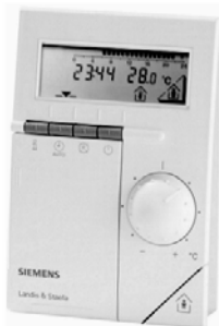
Appareil d'ambiance QAW70, avec sonde d'ambiance, horloge de programmation, réglage de consigne et correction de consigne d'ambiance (bouton de réglage)
